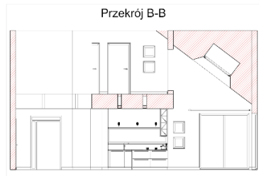
Rys. 580 – efekt przekroju stopniowego
