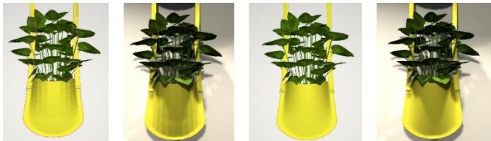
Rys. 730 – przykład elementu o zaoblonych kształtach bez wygładzenia (z lewej) oraz z wygładzeniem (z prawej)
