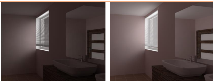
Rys. 731 – obiekt bez nadanej właściwości „Materiał dwustronny” oraz z nadaną właściwością (po prawej) – widoczny wpływ tej funkcji na rozkład oświetlenia
