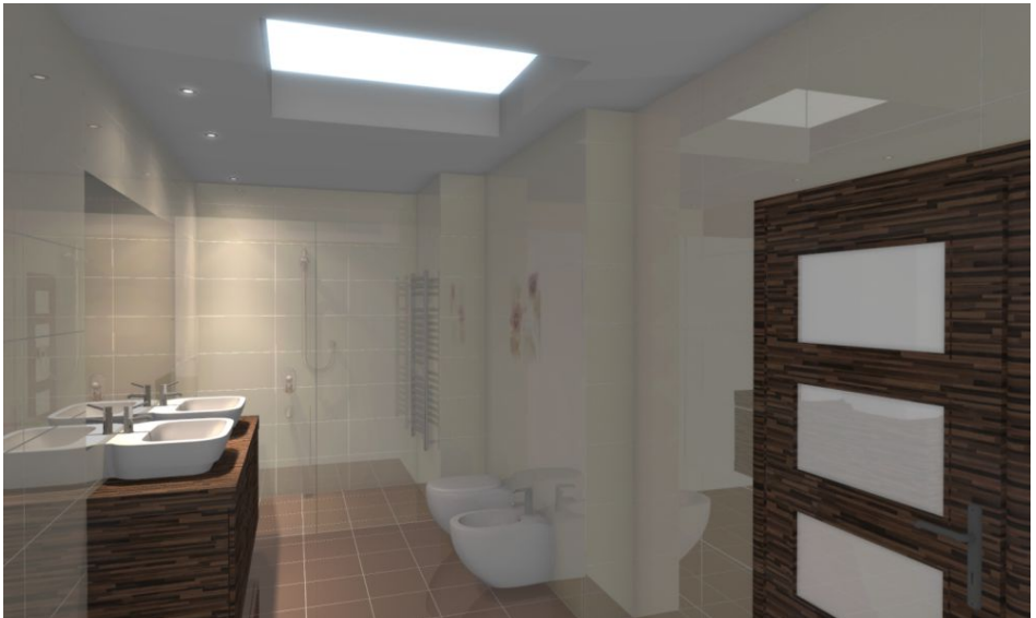
Rys. 643- RENDER PODSTAWOWY: W scenie są 3 halogeny i materiał w suficie, który ma nadaną emisję (podstawową) i jedynie symuluje światło (włączony efekt „Prezentacji emisji” - wydzielania poświaty). Podczas renderowania użyto funkcji „Globalne cieniowanie” i lekko rozjaśniono scenę (funkcja „Jasność”)
