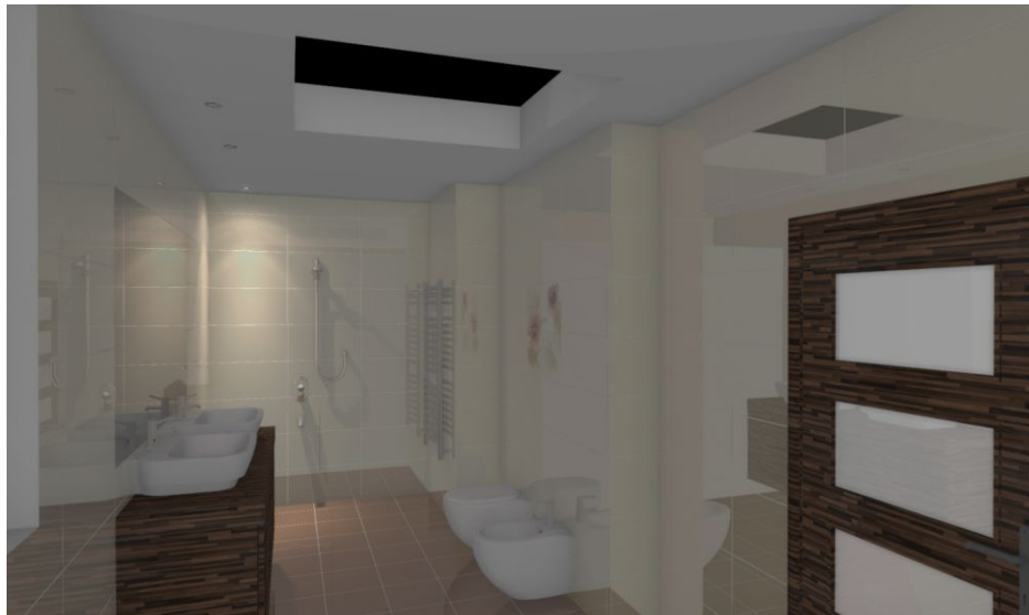
Rys. 641 - RENDER PODSTAWOWY: Do oświetlenia sceny użyto tylko jednego halogenu. Wymagane było dodatkowe rozjaśnienie sceny (funkcja „Jasność”), gdyż w innym przypadku byłaby ona niedoświetlona. W obu przypadkach użyto tych samych płytek, różnice w kolorystyce są więc wynikiem różnic w sposobie przeliczania dystrybucji oświetlenia.
