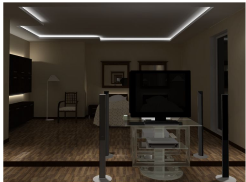
Rys. 628 – wykorzystanie Raytracingu widoczne na szklanym stoliku pod telewizorem (śledzenie promieni załamanych) oraz wielokrotne (10x) odbicia w lustrze (śledzenie promieni odbitych)
