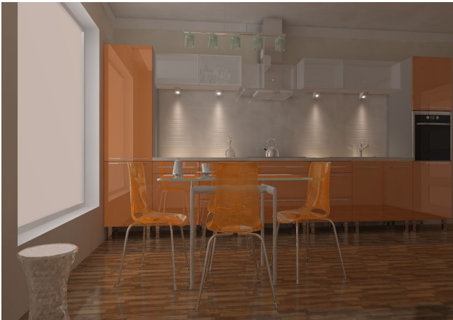
Rys. 640 - przykład wizualizacji kuchni - czas obliczeń 70 sek. (10 sek. raytracing 1x1 AA), procesor Core2 Duo E 8400.
