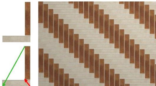
Rys. 388 – tworzenie układu płytek w „jodełkę”
