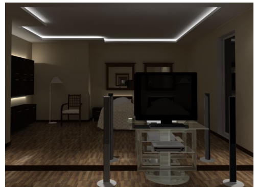
Rys. 476 - wykorzystanie Raytracingu: widoczne na szklanym stoliku pod telewizorem (śledzenie promieni załamanych) oraz wielokrotne (10x) odbicia w lustrze (śledzenie promieni odbitych)
