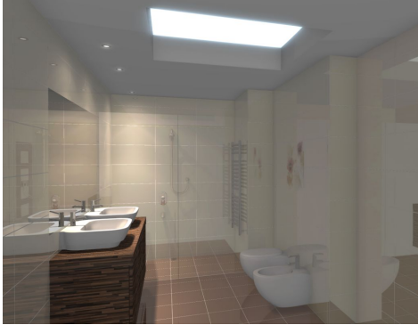
Rys. 501 - RENDER PODSTAWOWY: w scenie obecne są 3 halogeny i materiał w suficie, który ma nadaną emisję (podstawową) i jedynie symuluje światło (włączony efekt „Prezentacji emisji” - wydzielania poświaty). Podczas renderowania użyto funkcji „Ambient Occlusion” i lekko rozjaśniono scenę (funkcja „Jasność”)
