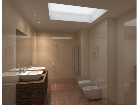
Rys. 502 - RENDER ZAAWANSOWANY: użyto tych samych 3 halogenów, ale świetlik wpuszcza przez sufit prawdziwe światło dzienne (a nie tylko je symuluje), co wyraźnie widać na krawędziach obiektów ceramicznych. Prosimy zwrócić uwagę na różnice w rozkładzie oświetlenia i barw w obu przypadkach
