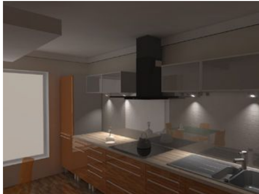
Rys. 485 - obliczenia GI dla sceny zawierającej błędne obiekty. Wyraźnie widać, że tam, gdzie występował kolor fukcyjowy, obraz jest zbyt ciemny (np. na okapie)
